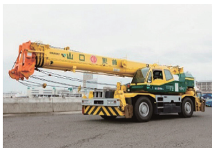
【25トンラフタークレーン】
